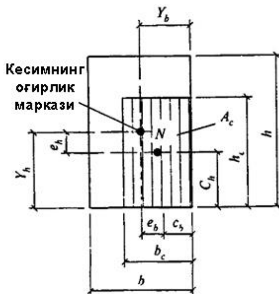
7-расм – Қиялама марказдан ташқари сиқилишдаги тўғри бурчакли кесимнинг ҳисобий схемаси
